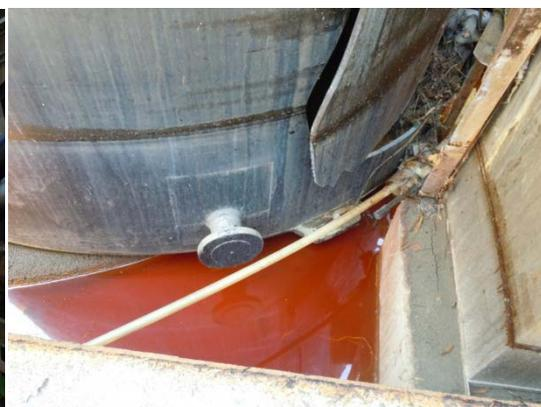
タンクが破損し、流出したポリ硫酸第二鉄
