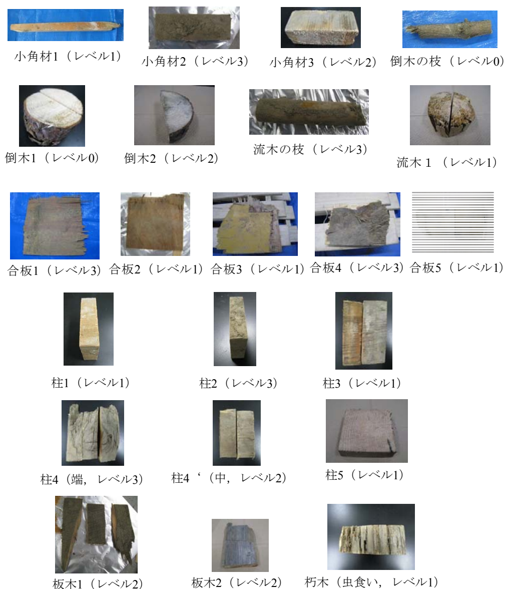
図 3-1-1 塩素含有量を測定した海水被り廃木材 (22 サンプル)
