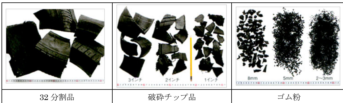
【図 8-7-4】タイヤチップの種類（日本タイヤリサイクル協同組合 HP）
